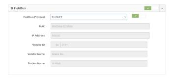
Fig. 44: PROFINET Fieldbus Protocols
